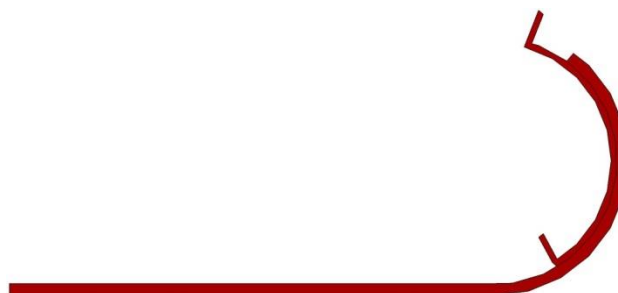
Výkres 4: Lopatkový sněhový zachytávač (boční pohled)
